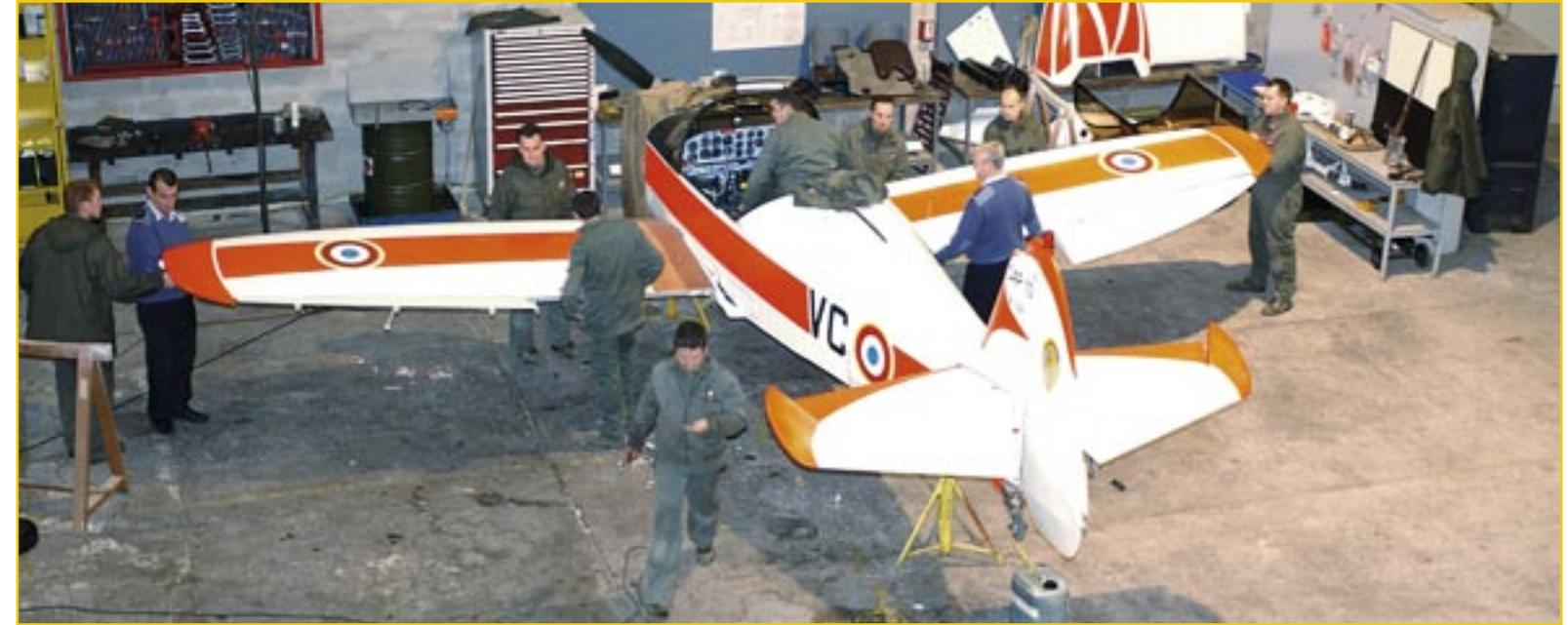
préparation et l'application des peintures et vernis. Cette phase nécessite attention et expérience. Par exemple, de l'application correcte des couches de peinture va dépendre le bon équilibrage de l'hélice du CAP 10B ou du JODEL D140.
